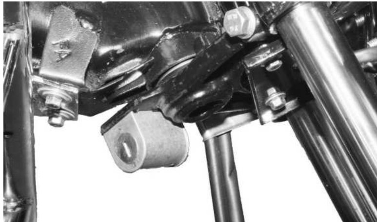
Рисунок 10. Замок блокування керма
