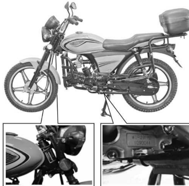
Рис. 7. Номери шасі та двигуна.
