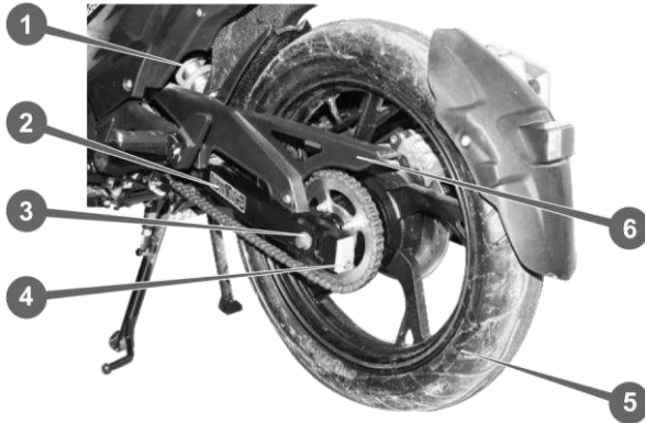
Рис. 6.7. Ланцюгова передача і маятникова підвіска
