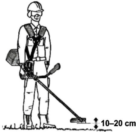
Рисунок 7. Регулювання наплічного пасового підвісу (ранцевого жилета).
