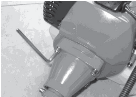
Рисунок 2. Схема приєднання стикувального вузла до двигуна виробу.
