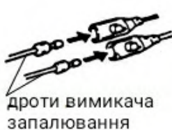
Рисунок 9. Схема під'єднання проводів вимикача запалювання.
