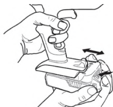
Рисунок 7. Схема встановлення акумуляторної батареї.
