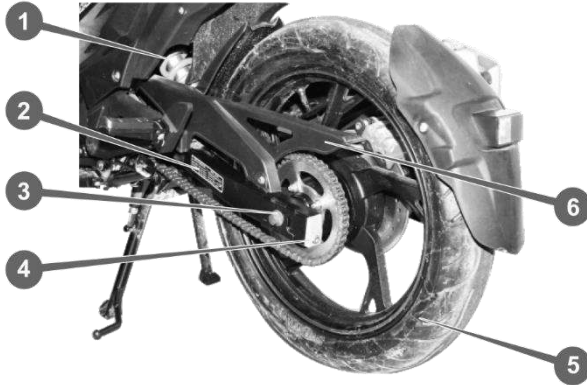
Рис. 6.7. Ланцюгова передача і маятникова підвіска
