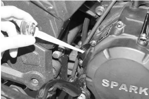
Рисунок 6.1. Перевірка рівня змащувального матеріалу в двигуні
