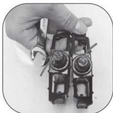
Під час встановлення педалі, зверніть увагу на позначення «R» та «L»
