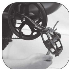
Для затягування педалі скористайтеся гайковим ключем.
