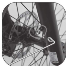
Встановлення крила на амортизатори (амортизатори постачають із гвинтами та прокладками).
