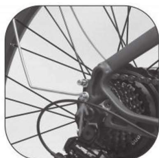
Заднє крило встановлюють знизу (так само з іншого боку).
