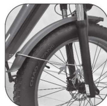
Встановлення крила на амортизатори (амортизатори постачають із гвинтами та прокладками).
