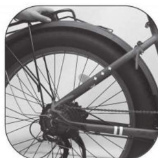
Задню стійку кріплять у два верхні отвори (так само з іншого боку).
