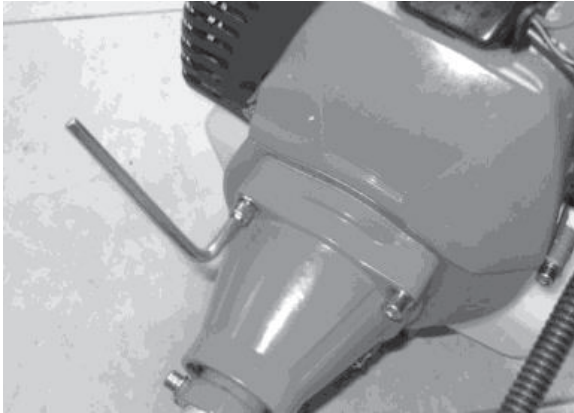
Рисунок 2. Схема приєднання стикувального вузла до двигуна виробу.
