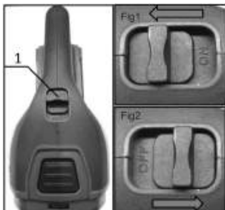
Рисунок 9. Схема увімкнення та вимкнення виробу.
