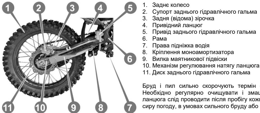
Рисунок 15. Ланцюгова передача і маятникова підвіска
