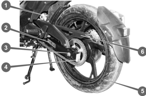
Рис. 6.7. Ланцюгова передача і маятникова підвіска
