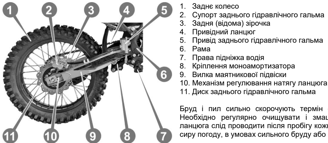
Рисунок 15. Ланцюгова передача і маятникова підвіска
