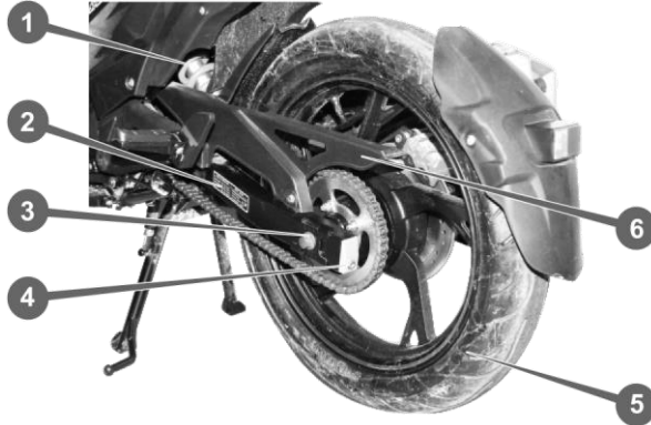
Рис. 6.7. Ланцюгова передача і маятникова підвіска
