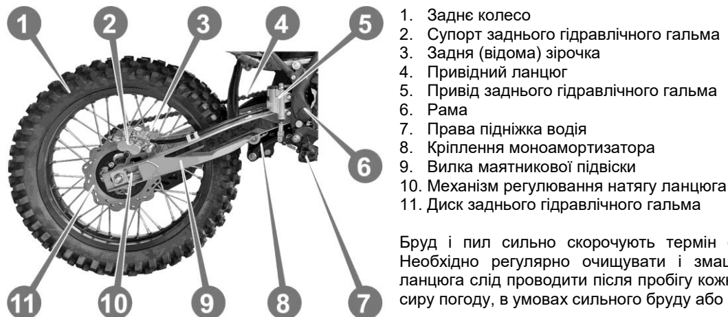
Рисунок 15. Ланцюгова передача і маятникова підвіска
