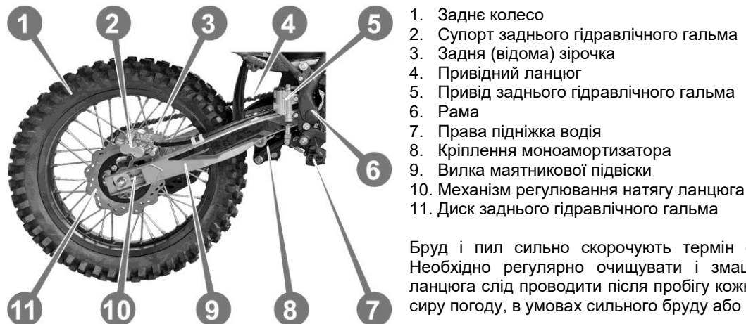
Рисунок 15. Ланцюгова передача і маятникова підвіска
