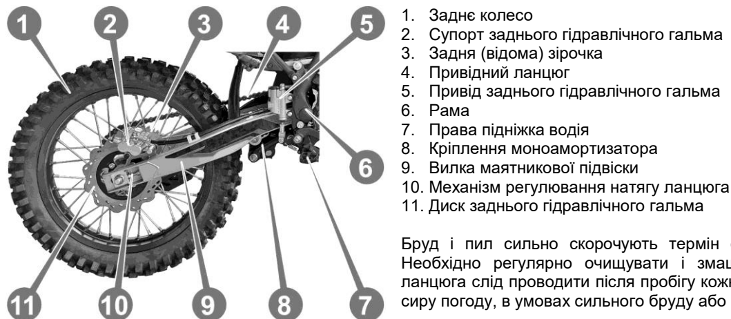
Рисунок 15. Ланцюгова передача і маятникова підвіска
