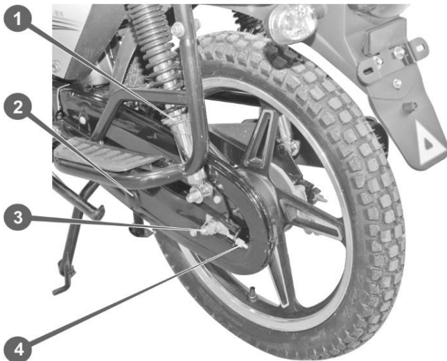
Рисунок 16. Ланцюгова передача і маятникова підвіска
