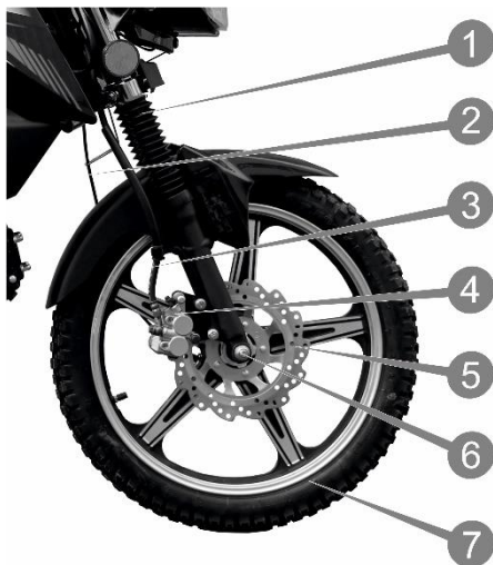
Рис. 17. Передня гальмівна система
