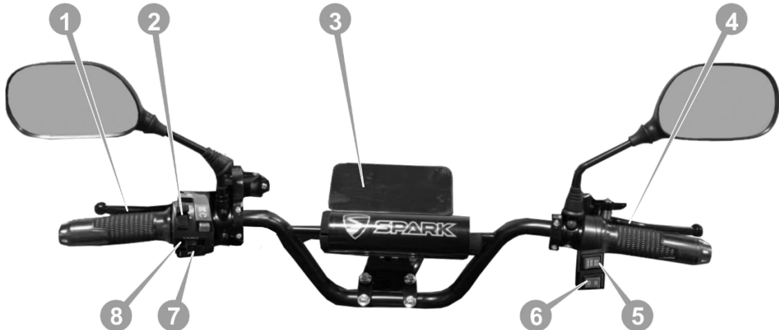
Рисунок 1.2. Блоки перемикачів на рукоятках керма.
