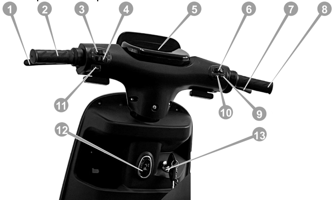
Рисунок 2.2. Кермо електроскутера, блоки керування на кермі
