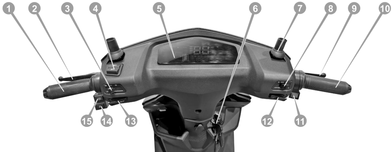
Рисунок 2.3. Кермо електроскутера, блоки керування на кермі
