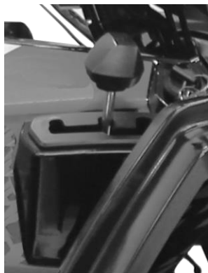
Рисунок 3.6 Важіль вибору напрямку руху для SP200-10 (2026)
