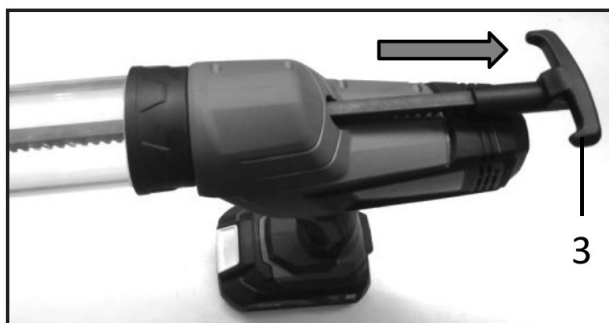
Рисунок 12. Встановлення зубчатого штока в початкове положення.
