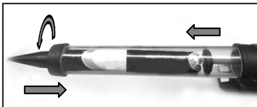
Рисунок 14. Встановлення кришки туби та сопла екструзійного.
