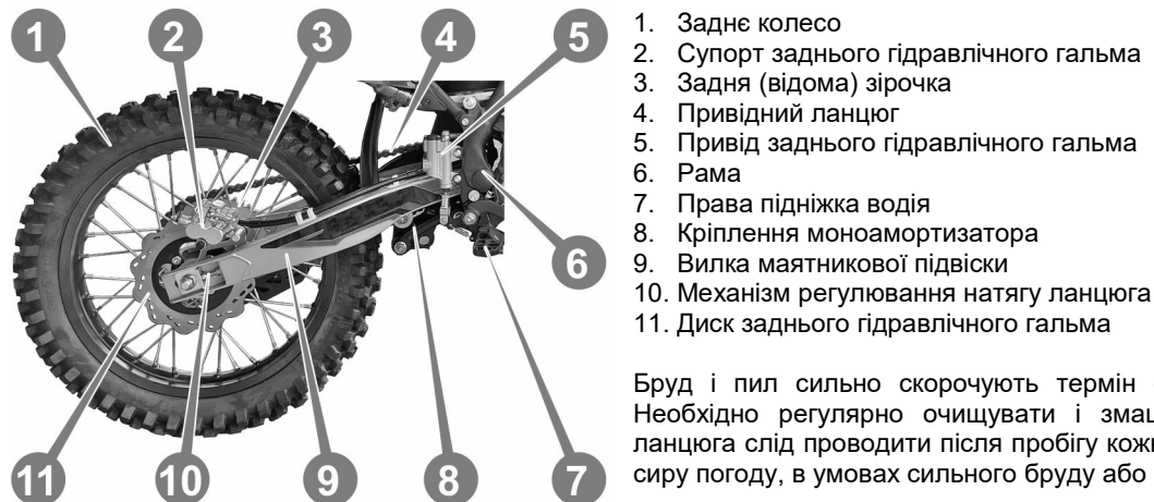
Рисунок 6.6. Ланцюгова передача і маятникова підвіска
