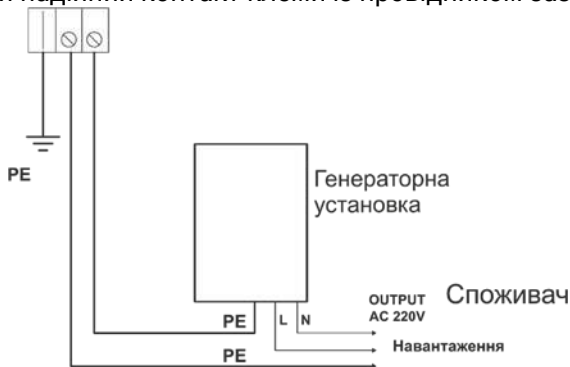
Рисунок 8. Схема заземлення виробу.
