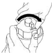
Рисунок 5. Кришка паливного бака з «дыхальним клапаном».
