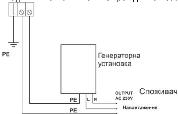
Рисунок 8. Схема заземлення виробу.
