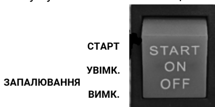
Рисунок 6. Схема роботи пускової клавіші двигуна.
