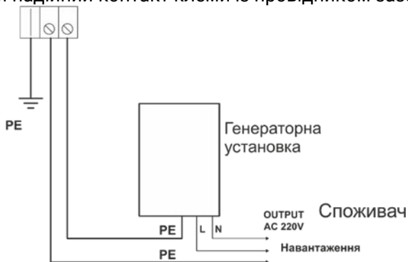
Рисунок 6. Схема заземлення виробу.
