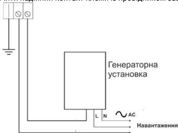
Рисунок 7. Схема заземлення виробу.
