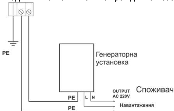
Рисунок 6. Схема заземлення виробу.
