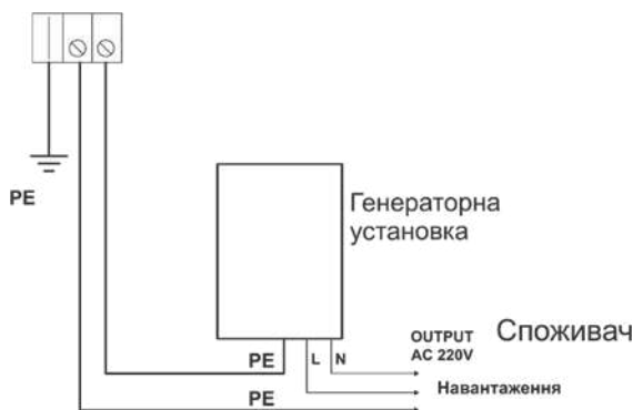
Рисунок 8. Схема заземлення виробу.
