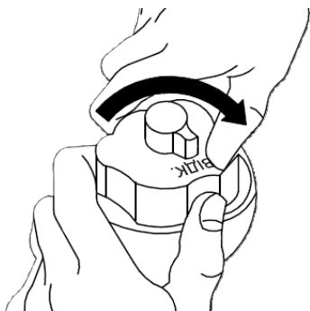
Рисунок 5. Кришка паливного бака з «дыхальним клапаном».
