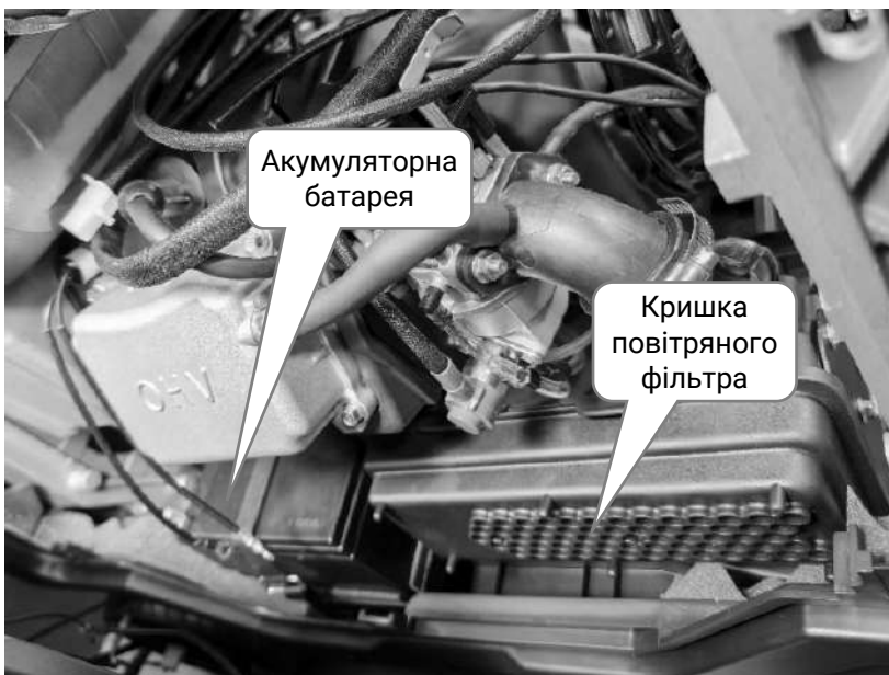
Рисунок 7. Модель «IG 13.0gsat dual power». Знята корпусна панель з лівої сторони. Доступ до кришки повітряного фільтра та акумуляторної батареї.
