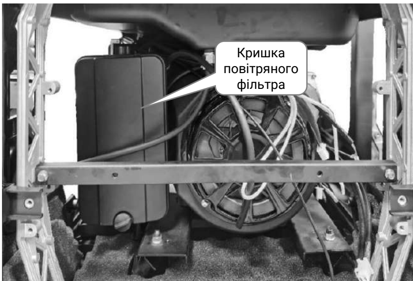
Рисунок 6. Модель «IG 9.0gsat dual power». Знята корпусна панель з фронтальної сторони. Доступ до кришки повітряного фільтра.
