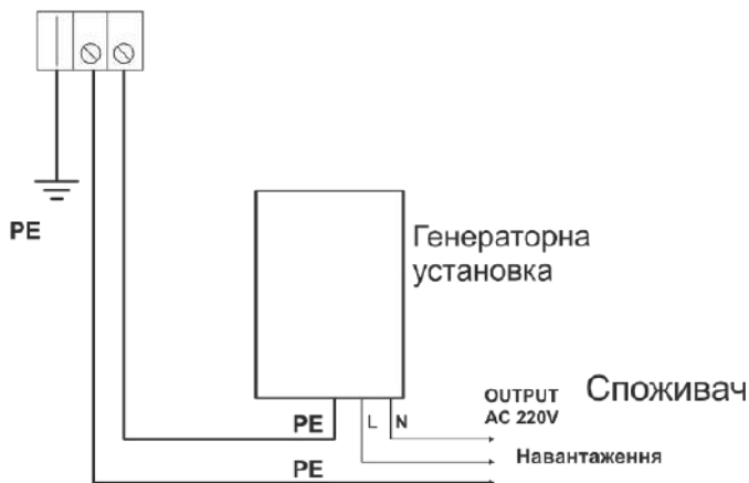
Рисунок 14. Схема заземлення виробу.
