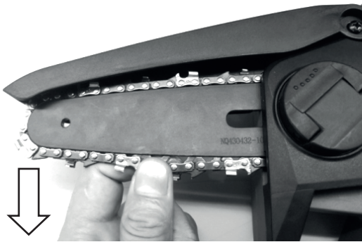
Рисунок 4. Перевірка натяжіння ланцюга.
