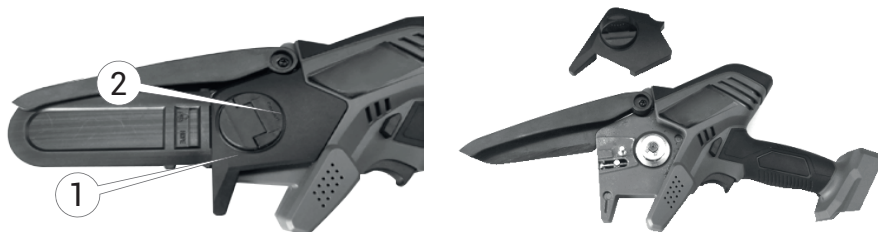
Рисунок 2. Зняття кришки кріплення «шини».
