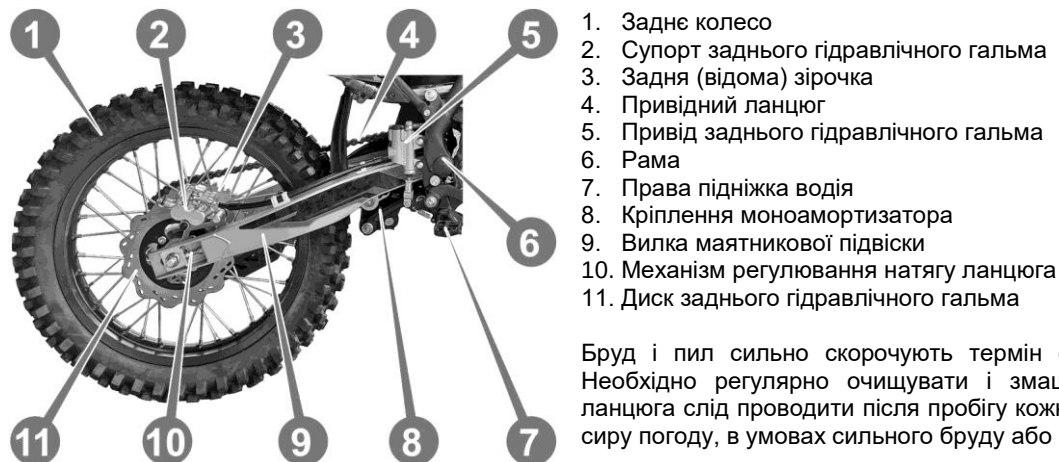
Рисунок 6.6. Ланцюгова передача і маятникова підвіска
