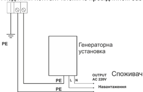
Рисунок 4. Схема заземлення виробу.
