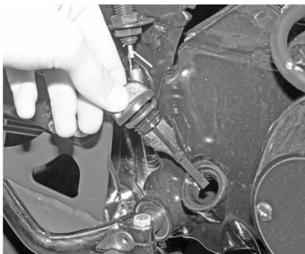
Рис. 5.1. Перевірка рівня мастила у двигуні
