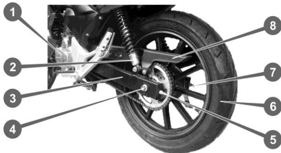
Рис. 5.3.1. Цепная передача и маятниковая подвеска
