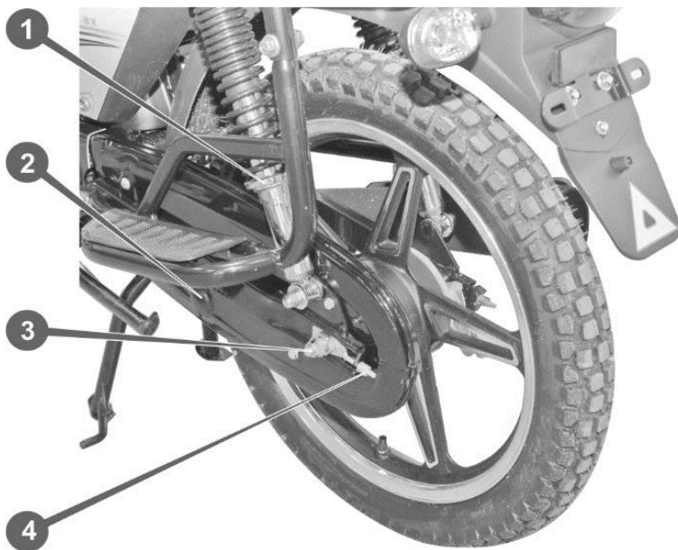
Рисунок 16. Ланцюгова передача і маятникова підвіска
