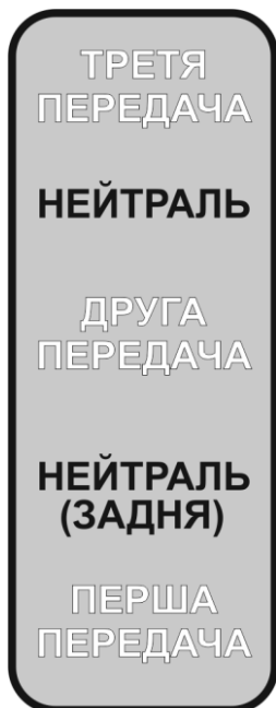
Рисунок 5.15. Послідовність перемикання передач
