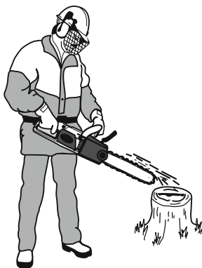
Рисунок 6. Схема перевірки роботи системи подачі мастила різального блока.
