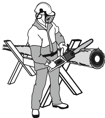
Рисунок 13. Схема розпилу колоди з використанням козлових опор.
