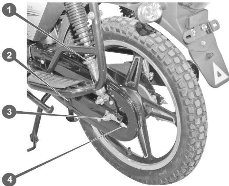
Рисунок 16. Ланцюгова передача і маятникова підвіска
