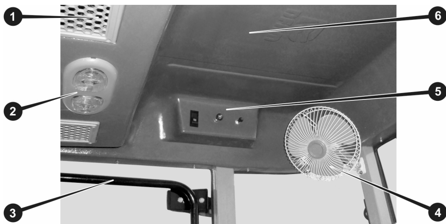
Малюнок 4.5. Обігрівач і вентилятор кабіни
