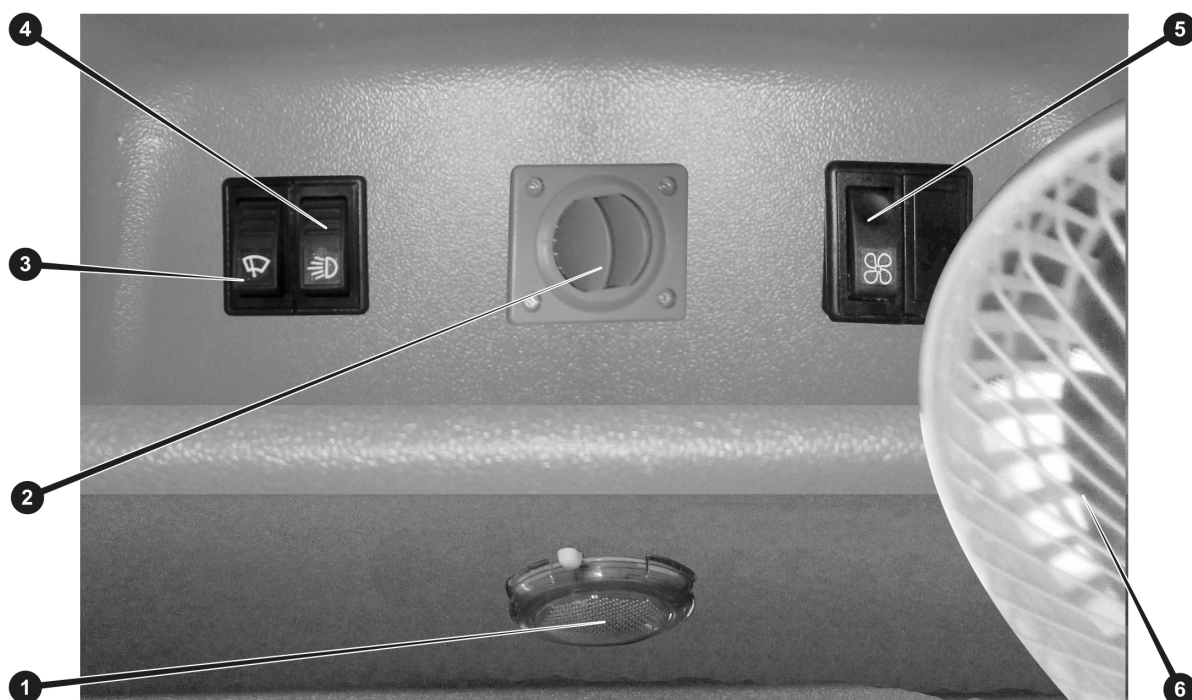
Малюнок 5.4. Опалювач-вентилятор кабіни
