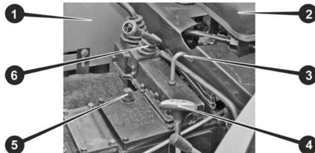
Малюнок 7.1. Масляна горловина картера трансмісії
