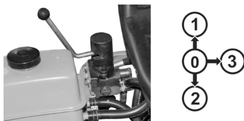
Рисунок 3.5.1. Позиції важеля гідророзподільника
