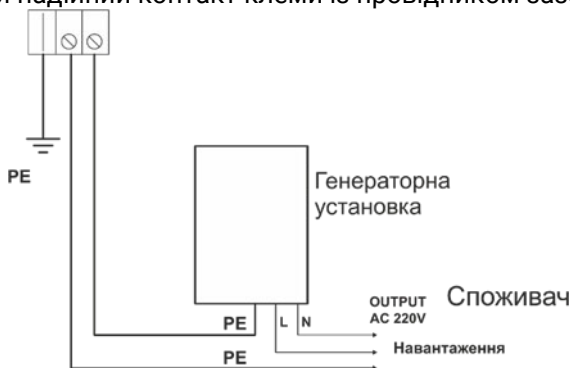
Рисунок 4. Схема заземлення виробу.
