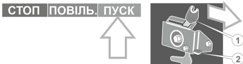
Рисунок 5. Схема роботи регулятора подачі палива двигуна.
