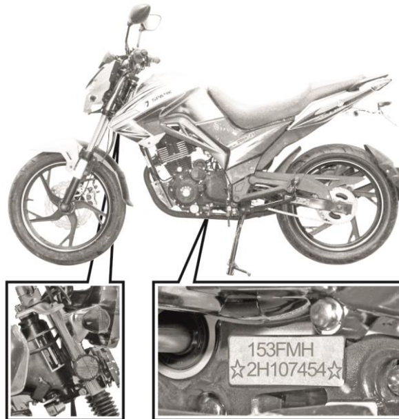
Рисунок 3.7. Розташування номера двигуна мотоцикла
