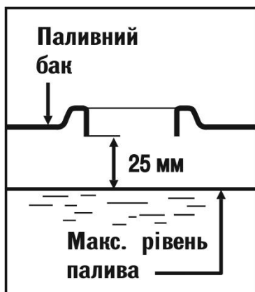
Рисунок 15 – Горловина паливного баку
