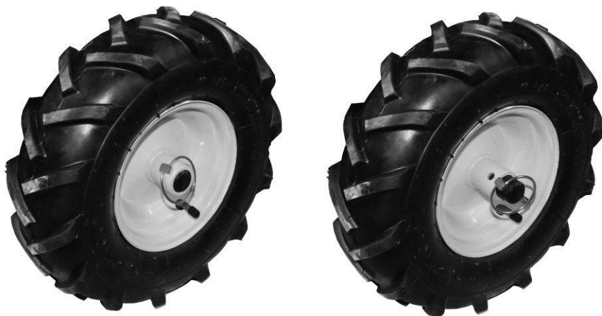
Рисунок 4.15. Ліве колесо з різними варіантами колії
