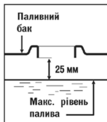
Рисунок 5.3. Горловина паливного баку
