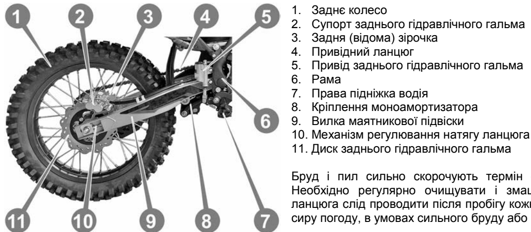
Рисунок 15. Ланцюгова передача і маятникова підвіска
