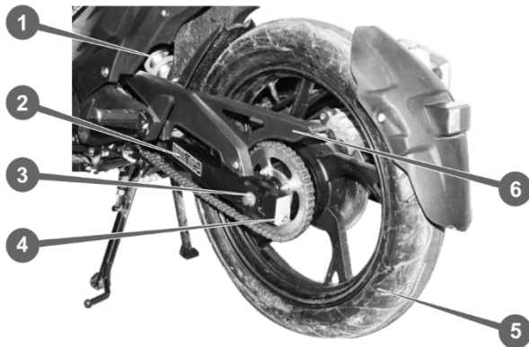
Рисунок 6.6. Ланцюгова передача і маятникова підвіска
